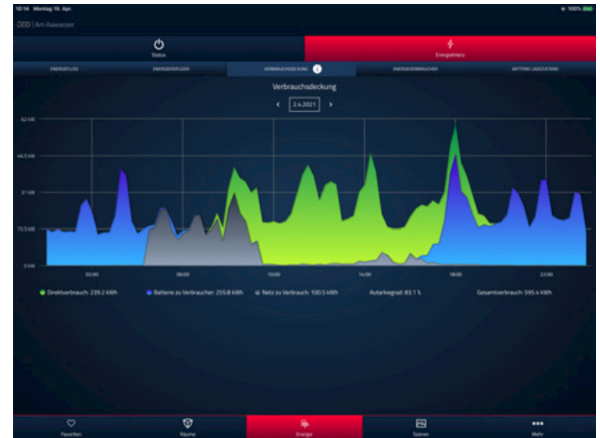
Optimierung des Eigenverbrauches durch das Energiemanagement / blau: Batterie, grau: Netzbezug EWN / grün: PVA Direktbezug
